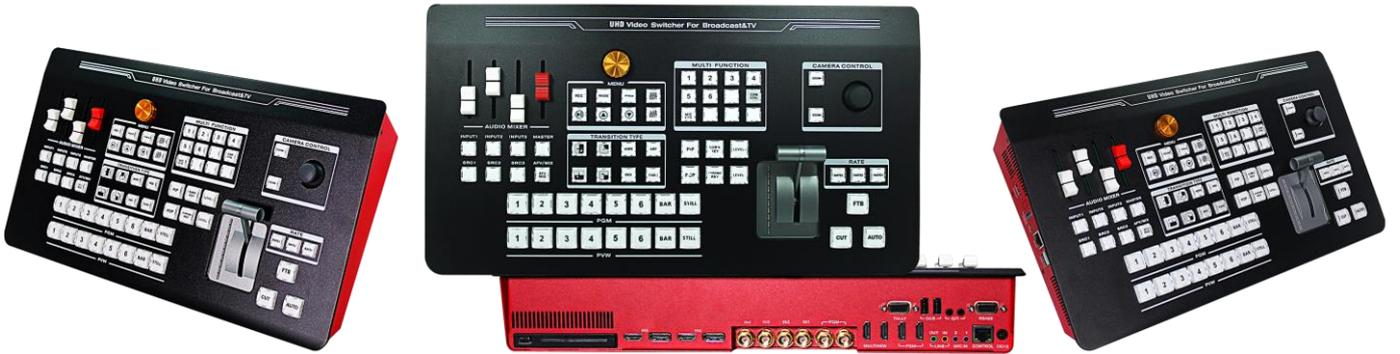
4K 级导播切换台,采用 SDI x 4+HDMI x 2+DP x 2 设计, 最多支持 8 路 4K60 超高清视频信号。可满足更多 OEM 客户的需求。主体框架如下:
