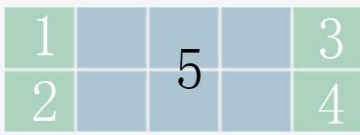
模式 1: 中间 2*3 拼接显示; 左右两边的四块屏独立显示
